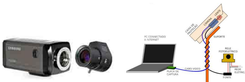
Figura 1 – Câmera SCB 2000 utilizada no sistema de captura e lente de razão focal 1.0 que é conectada a câmera. Ao lado, esquema seguido para a construção da estação. Fonte: www.bramonmeteor.org/bramon/
